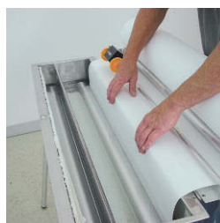
2. Das Gewebe mit Wasser aktivieren
